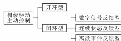
图3 常见栅极驱动主动控制方法分类
